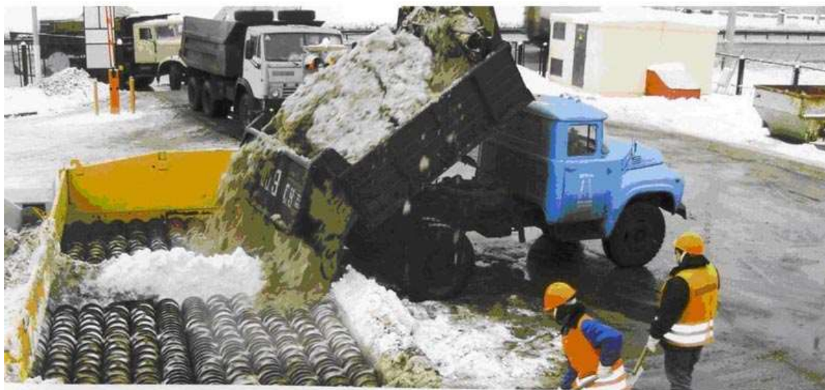
Выгрузка снега в приемный бункер сепаратора-дробилки стационарной снеготаялки
