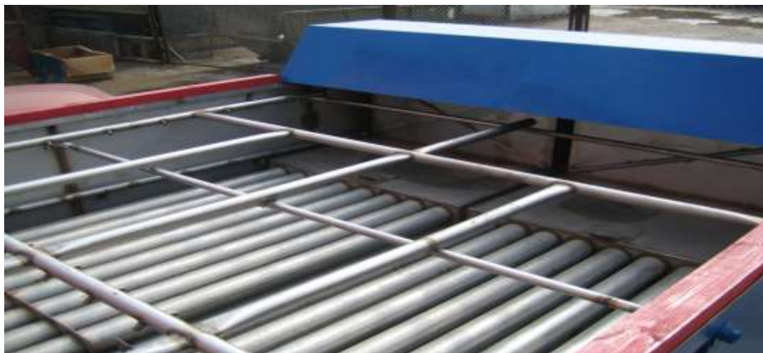
Прицепная мобильная снеготаяльная установка СПУ-10, смонтированная на двухосном прицепе, производства компании "ВТК-Пром" производительностью 20 куб.м в час с горелкой RielloRL (Италия)
