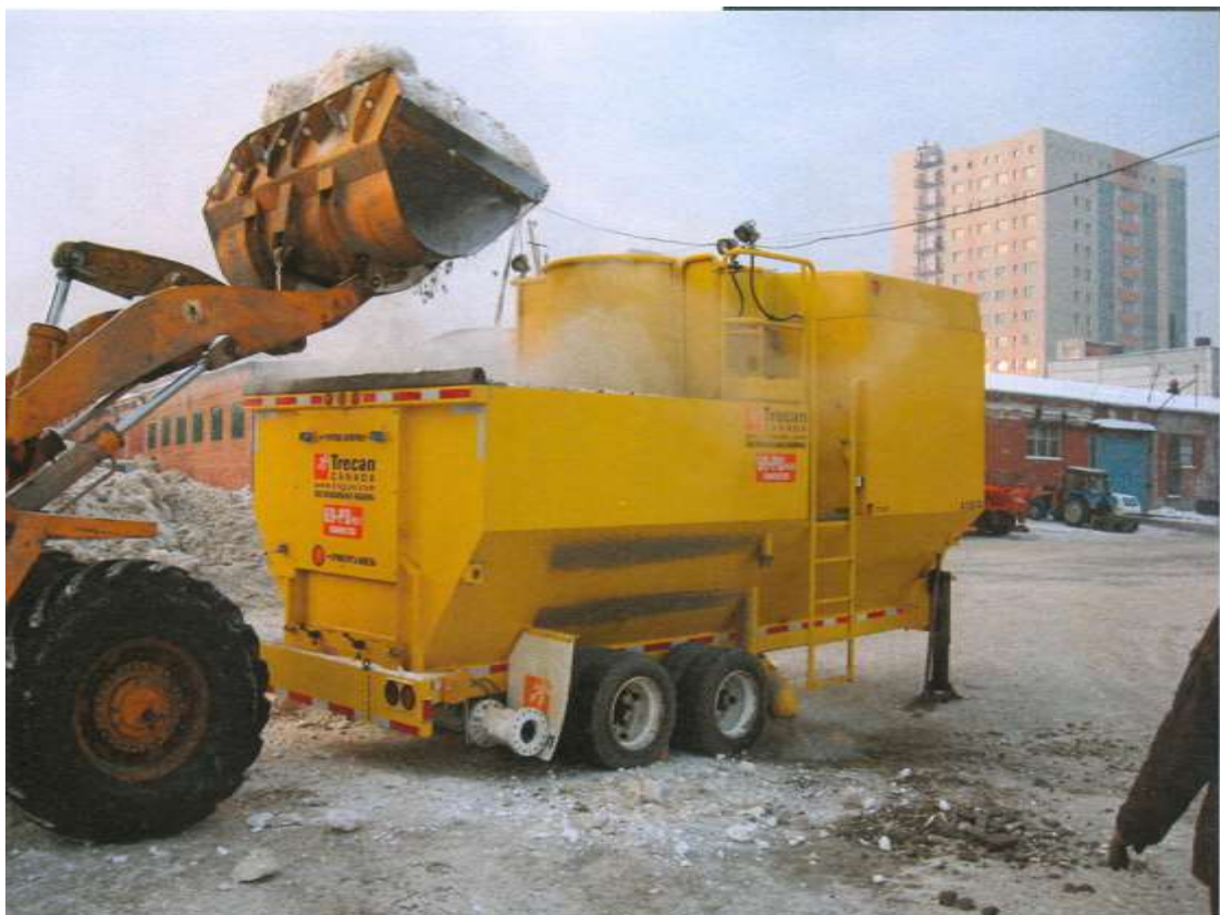
Передвижная модернизированная снеготаялка 60-PD канадской фирмы «TRECAN» в городе Новосибирске с устройством для удаления осадка из снеготаяльной камеры без остановки процесса плавления снега
