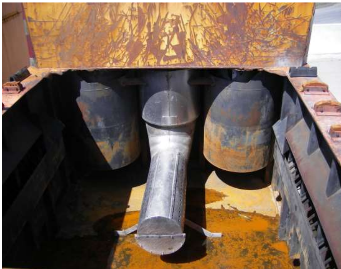
Система погружных горелок передвижной снеготаялки фирмы «TRECAN» производительностью 500 тонн в час с двухсторонней загрузкой
