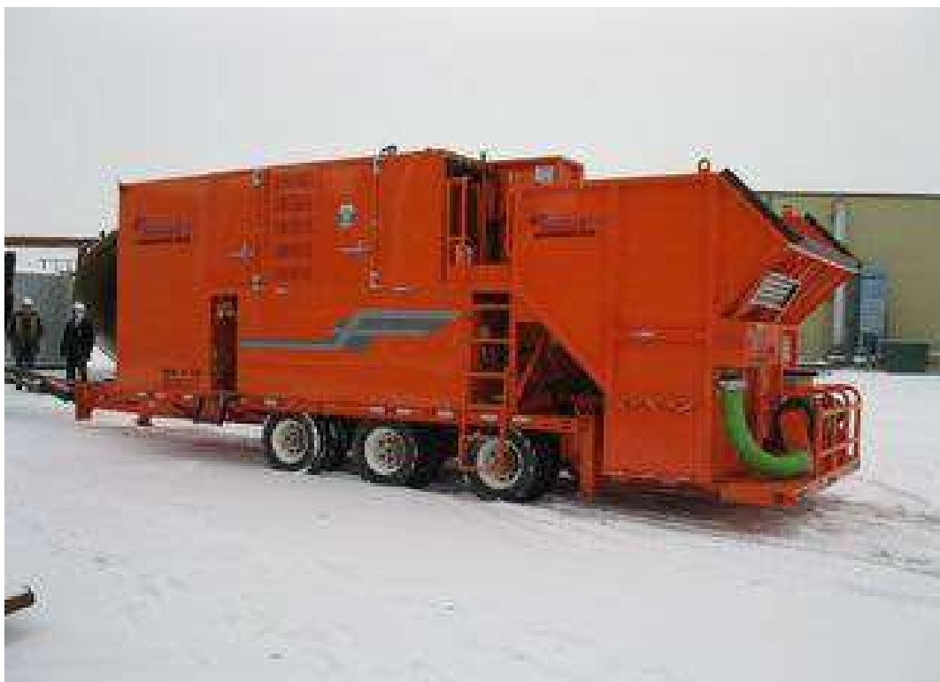
Прицепная мобильная снеготаялка - модель SRS 70 TPH, производства компании «Snow Removal Systems» производительностью 70 тонн в час с горелкой на дизельном топливе
