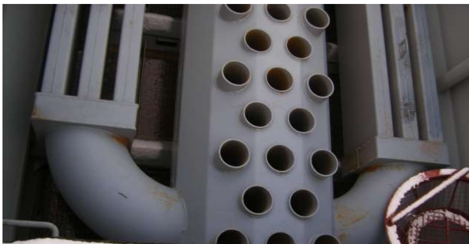
Снегоплавильная камера передвижной снеготаялки СТМ-12 конструкции ВНИИСтройдормаш»
