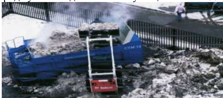
Передвижная снеготаялка ВНИИСтройдормаш СТМ 12 в работе.
