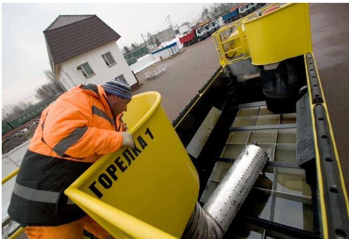
Система погружных горелок передвижной снеготаялки 135 - PDmx фирмы «TRECAN» производительностью 135 тонн в час с двухсторонней загрузкой
