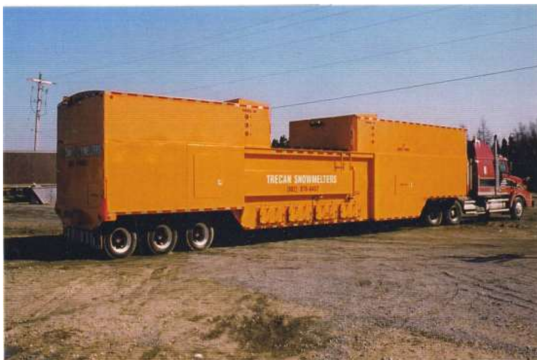
Мобильная снеготаялка 500 - PD фирмы «TRECAN» производительностью 500 тонн в час
