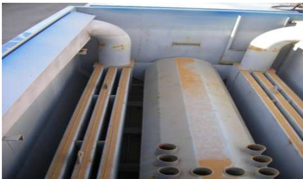
Снегоплавильная камера передвижной снеготаялки СТМ-14 конструкции ВНИИСтройдормаш»
