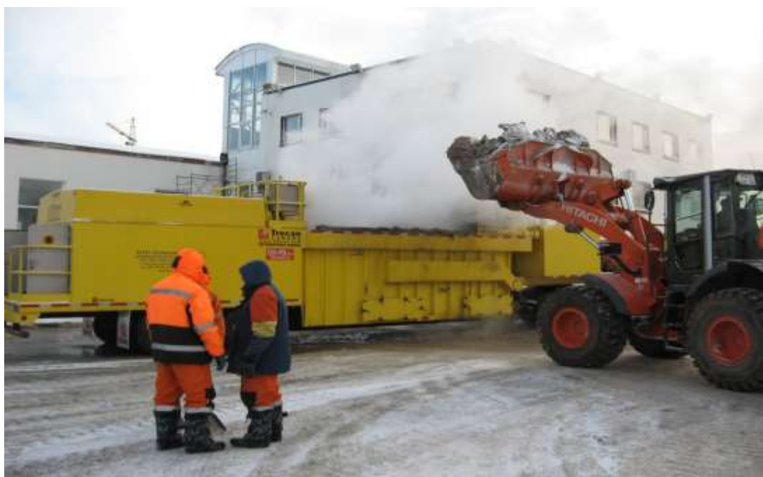
Передвижная снеготаялка 135 – PDmx фирмы «TRECAN» производительностью 135 тонн в час с двухсторонней загрузкой в городе Одинцово Московской области
