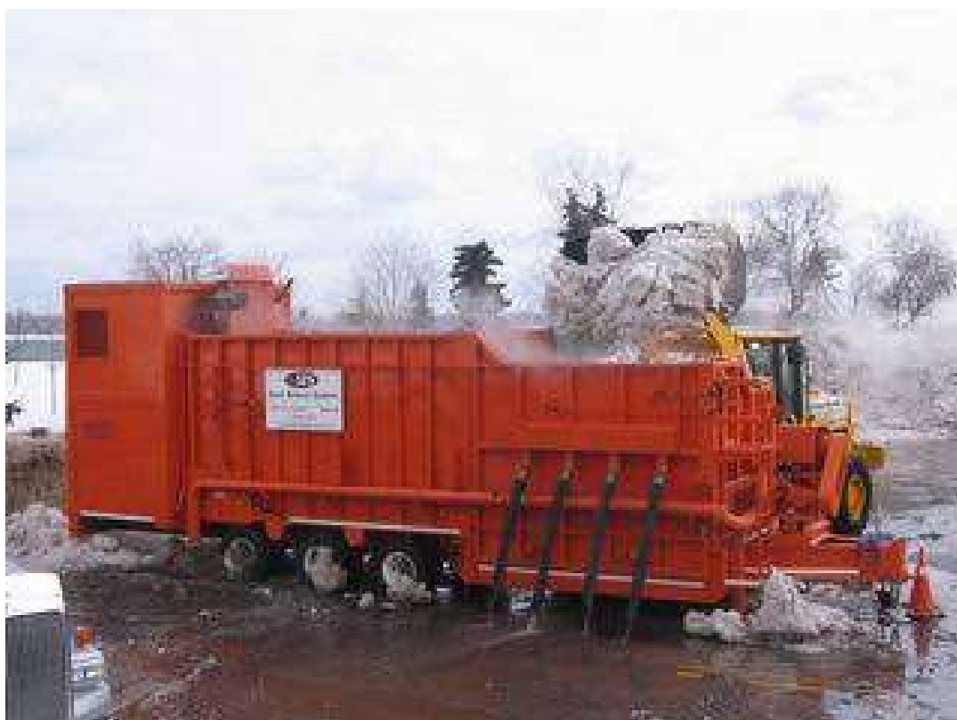
Прицепная мобильная снеготаялка - модель SRS 100, производства компании «Snow Removal Systems» производительностью 100 тонн в час с горелкой на дизельном топливе. Отвод талой воды из снеготаяльной камеры гибкими шлангами
