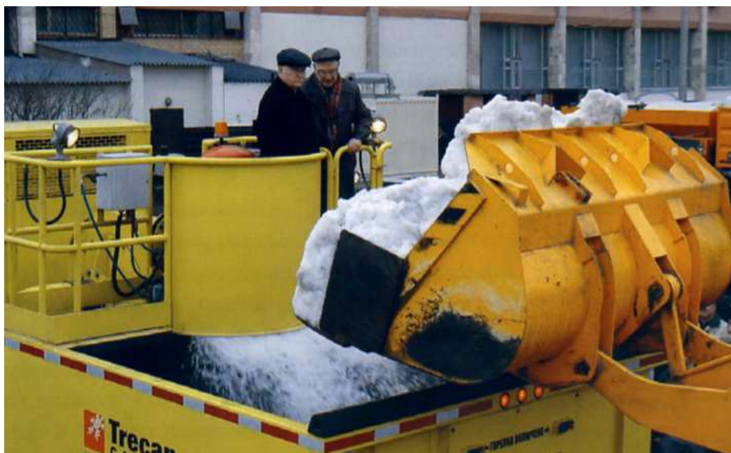
Передвижная снеготаялка 80 - PD канадской фирмы «TRECAN» - выброс горячей воды из наружной трубы горелки
