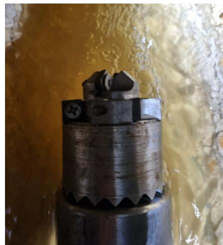
Передняя часть насадка с резцами, под действием струй воды вращается с высокой скоростью. За счет четырех центральных резцов спереди и четырех внешних резцов, расположенных по окружности насадка, он прорезает в твердых отложениях отверстие диаметром 80 мм.
